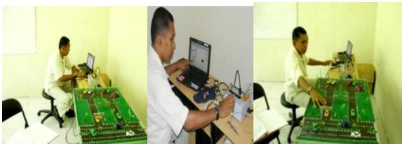
Pengujian program PLC pada maket simulasi kontrol sistem parkir otomatis
