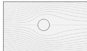
Gambar 5. *Streamline pada Re<sub>D</sub> 2 dengan menggunakan fluida udara*
