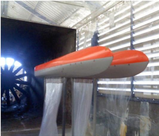
Gambar 1 A) Model katamaran dan pemasangan *pressure tape*, B) *test set up* dan pengujian aliran kecepatan, C) *test set up* dan pengujian distribusi tekanan.
