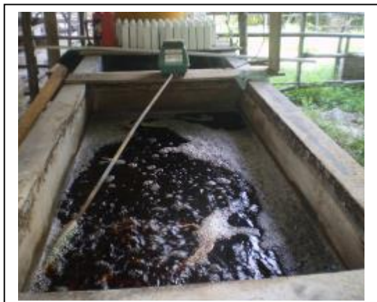
3c. Aerasi selama 2 minggu sampai bau urin hilang
