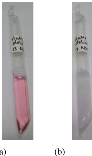
Gambar 5. Emas nanopartikel hasil sintesis dengan metode elektrokimia (AuNp I), (a) pada suhu ruang, (b) pada suhu 1^\circ\text{C} .
