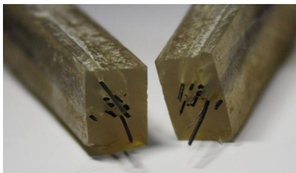
Gambar 4.4. Pola Patahan pada Uji Tarik Komposit
