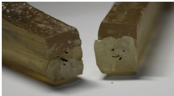
Gambar 4.1. Pola Patahan pada Uji Tarik
