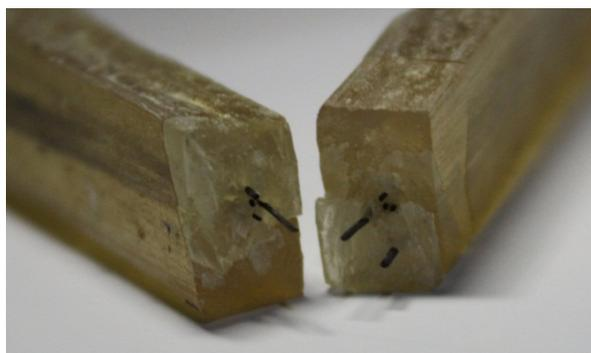
Gambar 4.2. Pola Patahan pada Uji Tarik
