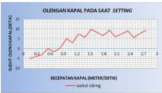
Gambar 6 Grafik stabilitas pada saat setting
