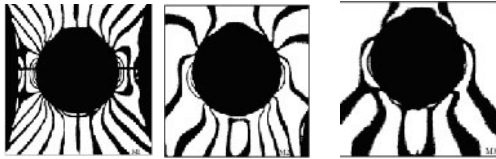
Gbr 8 . Fotogram model №1,2 dan 3 cylinder head dengan pembesaran pada zona lubang nozzle bahan bakar, dengan gaya tarik P = 450 N
