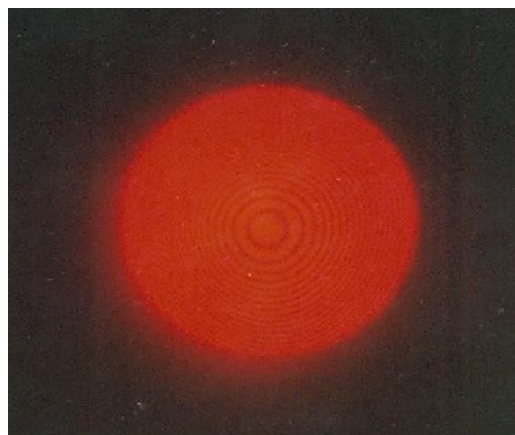
Gambar 12. Pola Interferensi yang terbentuk dengan penyaring ruang
