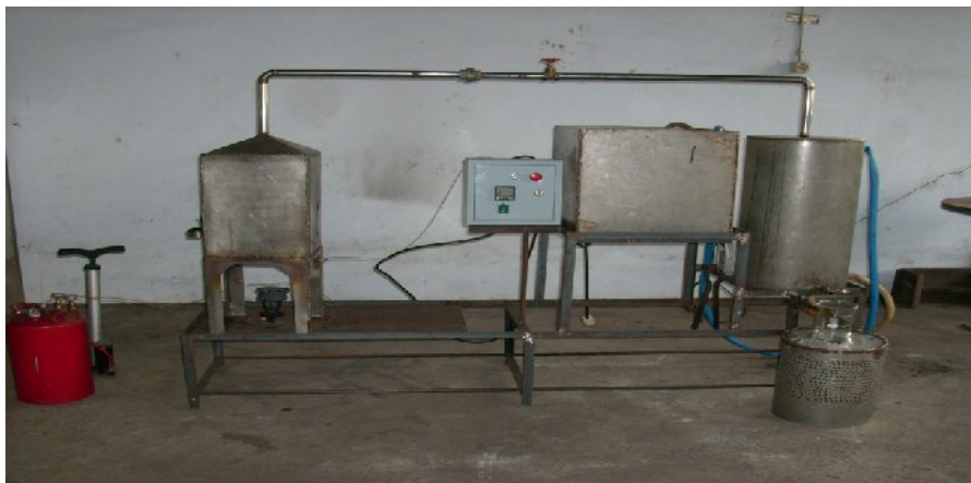
Gambar 1. Alat Pembuatan Asap Cair
